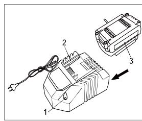
**ВНИМАНИЕ!** Чтобы сохранить работоспособность Li-Ion батареи она не должна заряжаться при температуре ниже 0°C или выше 45°C. Если температура аккумуляторной батареи выше 45°C или ниже 0°C, процесс заряда батареи не произойдет. При этом индикатор (1) будет гореть зеленым после подключения зарядного устройства к батарее. Если аккумуляторная батарея повреждена, процесс заряда батареи не произойдет. При этом индикатор (1) будет гореть зеленым после подключения зарядного устройства к батарее.
