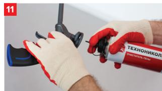
После завершения работ необходимо тщательно очистить пистолет с помощью очистителя монтажной пены ТЕХНОКОЛЬ.
